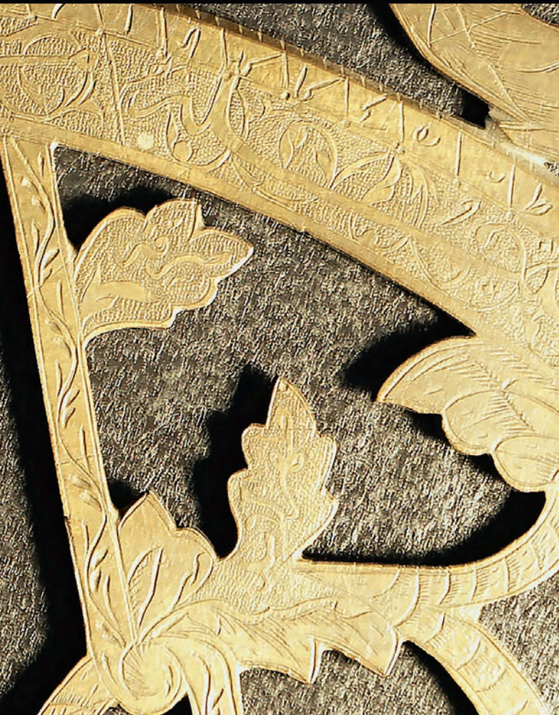
● Фрагмент паука большой астрольбии из Эрмитажа. На нём три листика: тот, что справа, чисто декоративный, на двух других написаны арабские названия звёзд.
